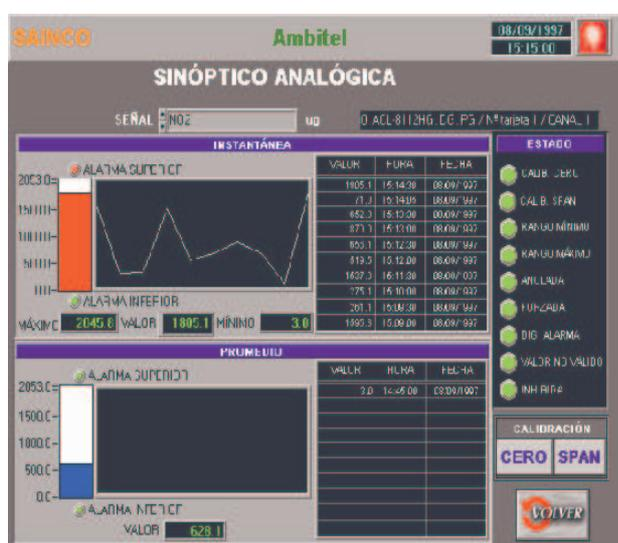
Este software foi desenvolvido mediante o Labview, que constitui uma ferramenta padrão para trabalhar com sistemas de gerenciamento de dados em tempo real.
